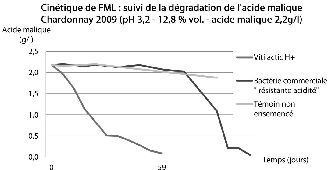
Comparaison entre VITILACTIC® H<sup>+</sup>, une biomasse de référence et un témoin non ensemencé sur un vin chardonnay 2009 à 16°C. Résultat expérimental IFV.
